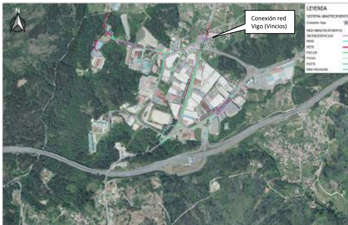
Figura 35. Conexión con red de abastecimiento de Vigo.
